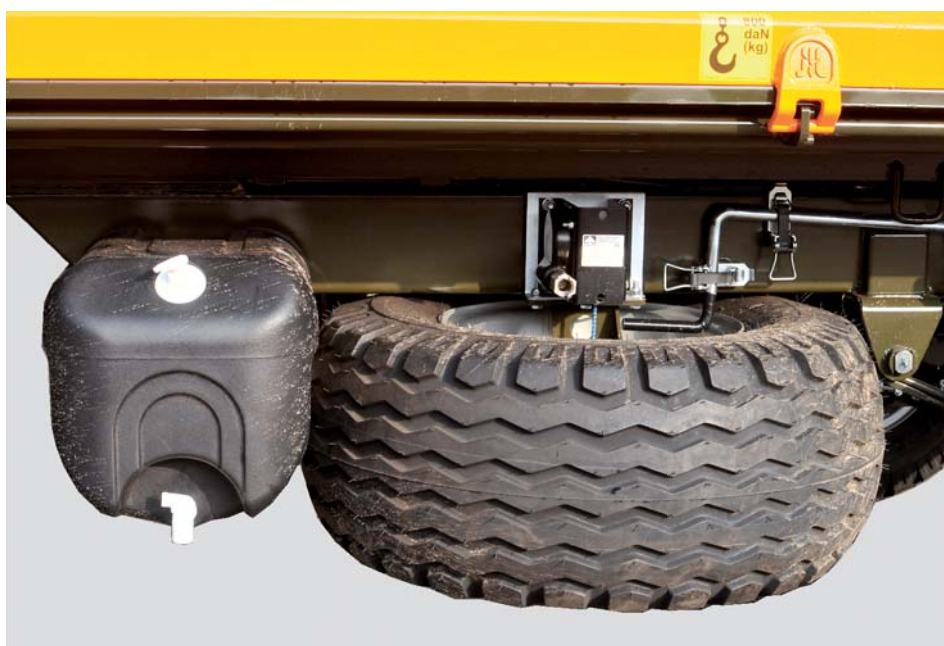
Фотография: Дополнительное оснащение прицепа RT606: запасное колесо с лебёдкой прикрепленное к раме шасси. Рядом с ёмкостью для воды и мылом.
