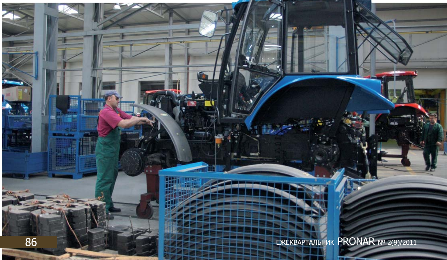
Фотография: Монтаж деталей из пластмассы
